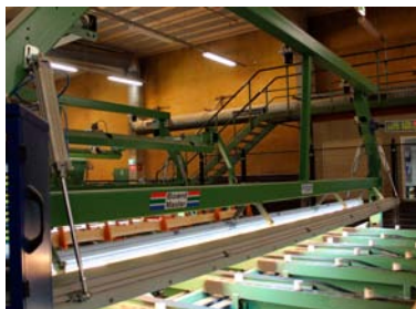
Entre los parámetros que analizan estos equipos se destacan las dimensiones del tablero, nudos, fisuras, curvatura, hongo azul, pudrición, inclinación de la veta y bolsa de resina.
